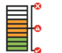
Желтая зона Давление на сверло слегка превышает рекомендованное, сбавьте давление для возврата в зеленую зону.
