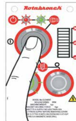
2) Включение магнита Чтобы активировать или деактивировать магнитное сцепление, нажмите большую кнопку по центру. Зеленый диод загорится, информируя о готовности станка к работе.
