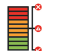
Красная зона Перегрузка: немедленно сбавьте давление, в противном случае двигатель аварийно выключится.
