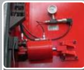
Гидравлическая регулировка натяжения полотна
