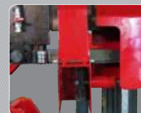
Щетка очистки полотна
