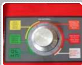
Регулировка подачи в зависимости от материала
